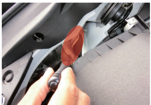
画像③フロントインサイドパネルにある抜き打ち穴周辺は、損傷多発エリア(赤分)
