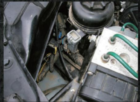
ハーネスを束ねるチューブの凹凸部分、また、テープで束ねている場合には、テープが縮むことが多く、糊が付着している部分の砂の付着が目立ちます。
