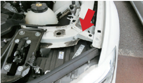
画像②フロントフェンダーから入った衝撃エネルギーはこのステーを経由します
