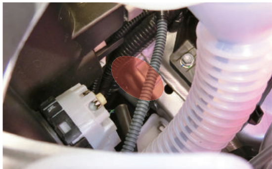
フェンダーステア取り付け部周辺はとくに注意！（画像は右フロントインサイドパネル）
