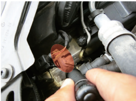
サイドメンバーとラジエータコアサポートの接合部分の状態を確認しましょう(画像は右側)
