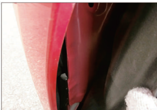
画像②左フロントインサイドパネル先端部
