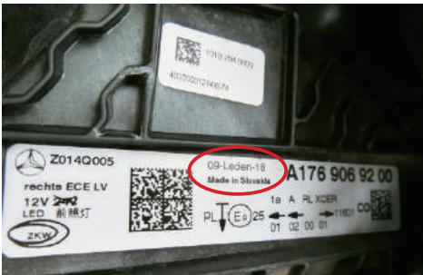
画像②ヘッドライトにあるラベルで製造日がわかる!
