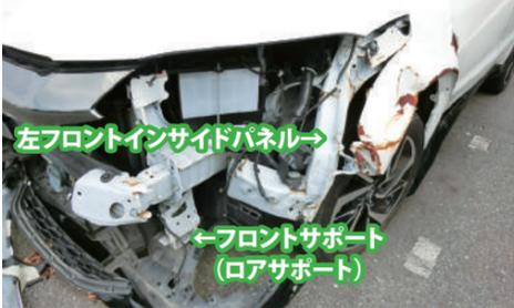
画像②損傷したフロントインサイドパネル
