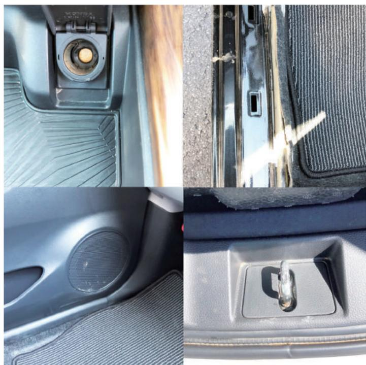
左上から右回り>シガーソケットの中に錆が。フロアマットをめくると土が残る。トランクのヒンジにも錆。ドアスピーカーの下部に冠水した跡
