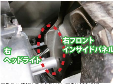
画像② 先端部は損傷多発地帯 (画像は新車状態)
