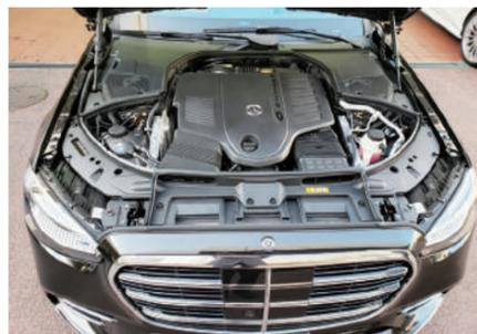
エンジンルームは多くの部分が綿素材の吸音材でカバーされている(撮影:編集部)
