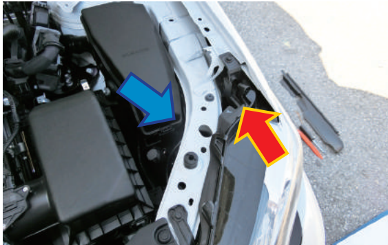
画像②フェンダーフランジ部のカバーを外す
