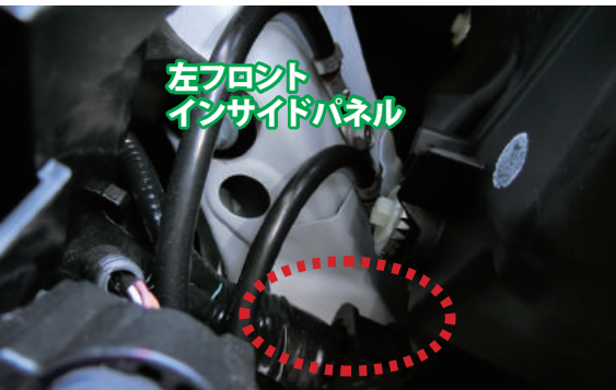
画像④先端部は損傷、修正跡が発見されやすい (同)
