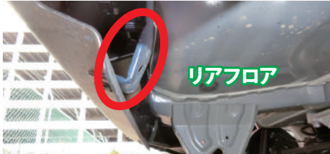
画像⑥バンパーステータ取り付け部は要注意！（画像は新車状態）
