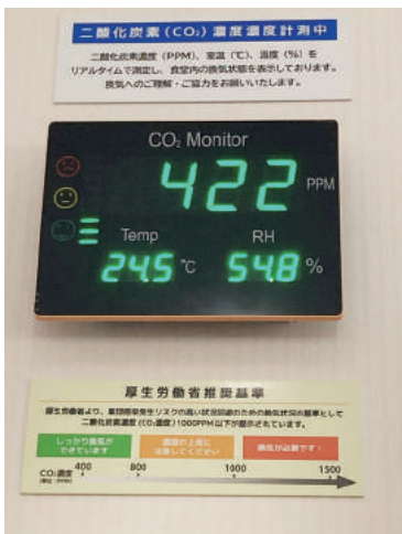
CAA中部の食堂内に設置した二酸化炭素濃度測定モニター
