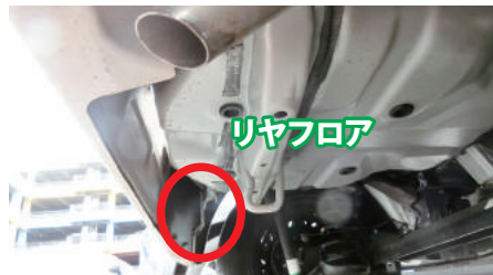
画像⑥バンパーステー取り付け部は要注意！ (画像は新車状態)
