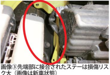
画像③先端部に接合されたステーは損傷リスク大(画像は新車状態)
