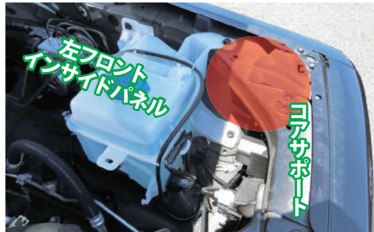
画像②フロントインサイドパネル先端部分は、損傷リスク大 (画像は新車状態)
