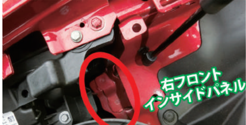
画像②フロントインサイドパネル先端部分は、損傷リスク大 (画像は新車状態)
