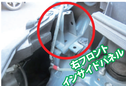
画像②上面のステア (赤丸) の取付状態に不自然な点がないか? (画像は新車状態)
