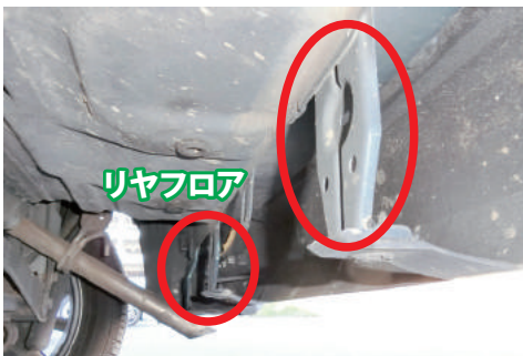
画像⑤バンパーステア (赤丸) は押されやすく接合部分に隙間が生じやすい (同)
