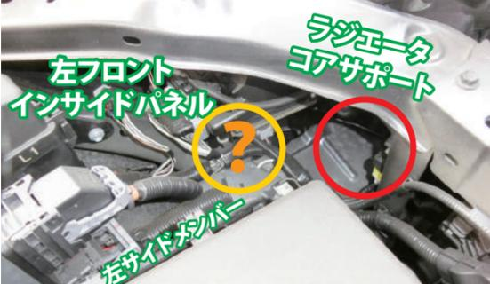
画像② サイドメンバー先端部(赤丸)は見えるが、フロントインサイドパネル先端部(黄丸)は微妙……(画像は新車状態)
