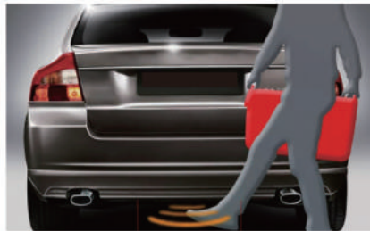
車体の下に足をくぐらせてトランクを開ける機能。国産車、輸入車のいずれでも装備削減対象、あるいは長納期化の理由となっている
