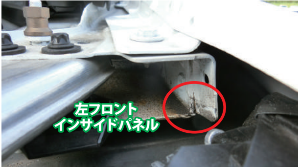
画像③ 損傷している先端部
