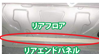
画像④リヤエンドパネルとリヤフロアの接合部に塗布されたシーラント (同)
