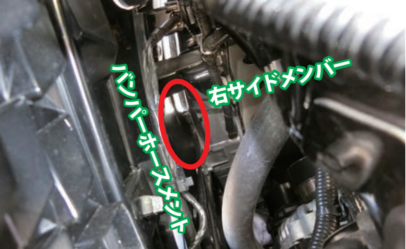
画像③ 接合部分付近は要注意！（画像は新車状態）
