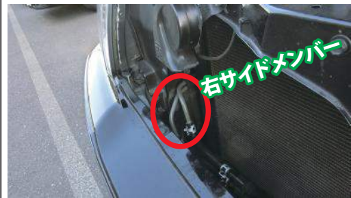
画像④ 損傷リスクの高いサイドメンバー先端部 (画像は新車状態)
