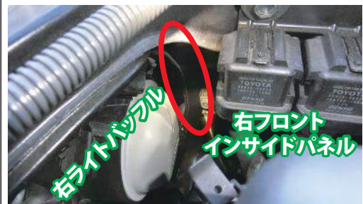
画像③ 不自然な隙間が生じていないか？ (画像は新車状態)
