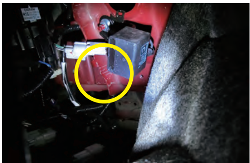
画像③ タイヤハウス側から覗くとフレーム修正機跡が確認できる (画像は姉妹モデルのRAV4)
