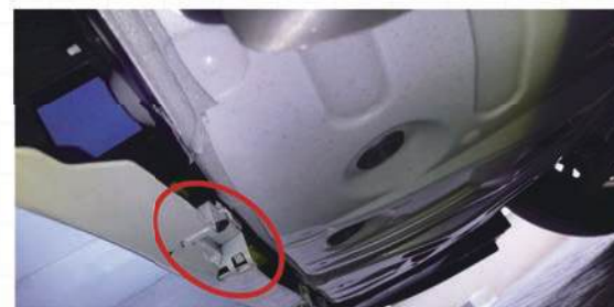
画像⑥バンパー取付ステー部分は損傷リスクが高い (画像は新車状態)
