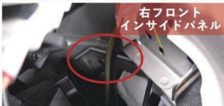
画像④先端部にあるステーは損傷リスク大(画像は新車状態)
