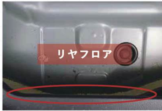
画像④塗布されているシーラントは正常? (画像は新車状態)
