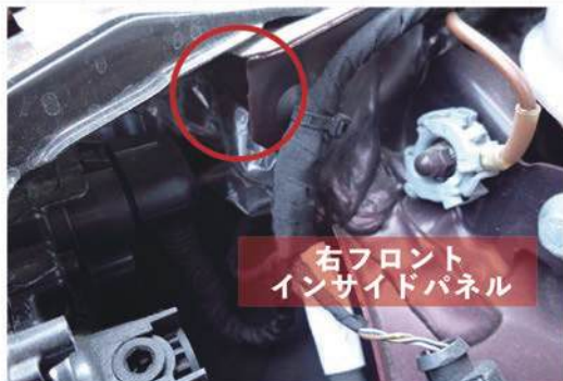
画像③先端部分は損傷リスクの高いエリア(画像は新車状態)
