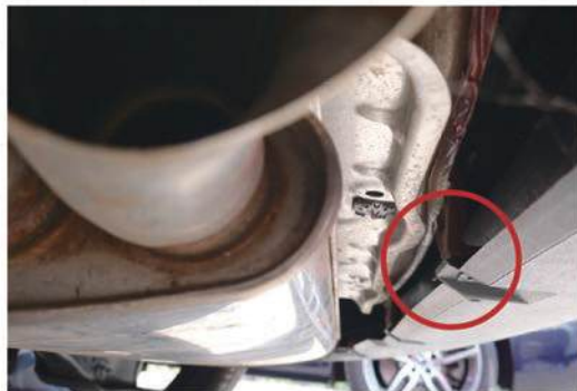
画像⑤バンパー取付ステーは損傷リスクの高いパーツ(画像は新車状態)
