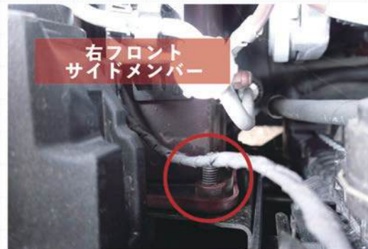
画像④フロントサイドメンバー先端部分も確認(画像は新車状態)
