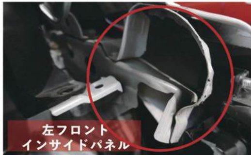
画像③大きく歪んだ上面の取付ステー
