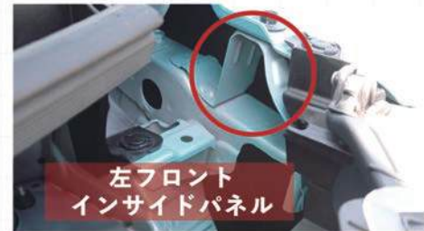
画像②先端部にある取付ステーも忘れずに! (画像は新車状態)
