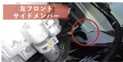
画像④ このくぼみ部分にシワが発生しやすい (画像は新車状態)
