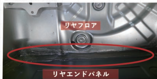
画像⑤ シーラントの上から塗装がされて不自然に見える (画像は修理された状態)
