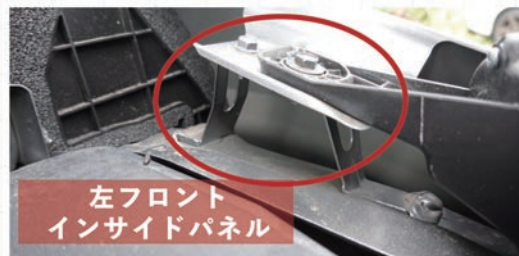
画像③ 取付ステー本体が損傷していないか? (画像は新車状態)
