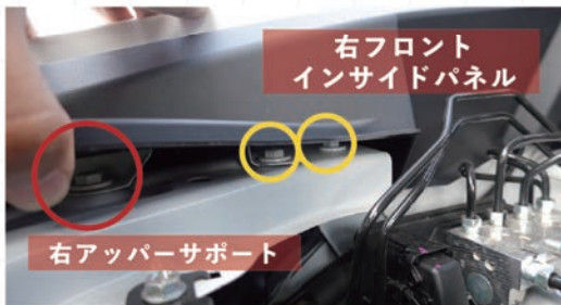
画像③隙間から見える3つのボルト (画像は新車状態)
