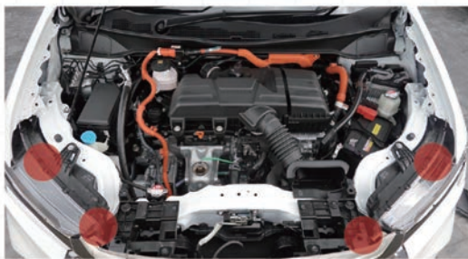
画像①4つのポイントを中心に修復歴チェック (画像は上部カバーを外した状態)
