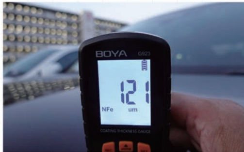
画像②アルミ合金と鋼板による大きな相違は無し (画像はボンネット測定)
