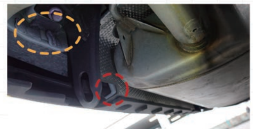
画像⑥ 左右両端エリアは下側から確認(画像は新車状態)
