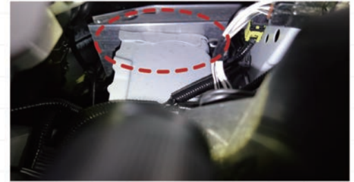
画像④ ホースメントとの接合部分は損傷リスク大(画像は新車状態)
