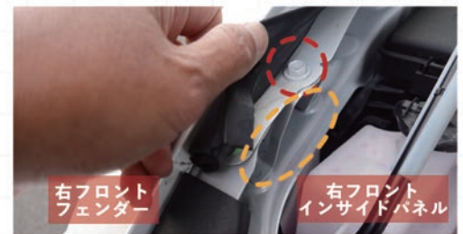
画像② フェンダー取付ボルトからステーの確認へ(画像は新車状態)
