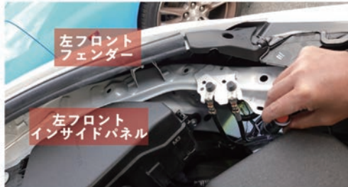
画像③ フロントインサイドパネル先端部確認は検査用ライト必須
