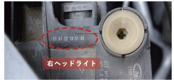
画像②日・月・西暦・時刻の順に表記(画像は2022年7月27日製造)
