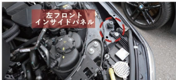
画像④フェンダーブラケットに注目（画像は新車状態）
