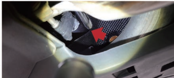
画像⑤リヤエンドパネルに塗布されているシーラント（画像は新車状態）
