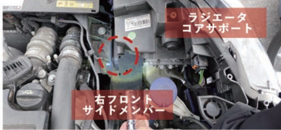
画像④フロントサイドメンバー先端もエンジンルーム側から確認可能
