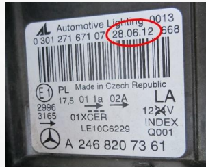
画像④ヘッドライトの製造年を年式と照合する (2012年6月28日製造)
