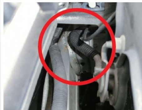
画像① ホースメントにめり込んだ右サイドメンバー先端部
