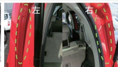
画像④左右で見比べてみる（右：再溶接、左：新車時溶接）
