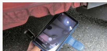
画像③スマホカメラや鏡を使用すると便利 （画像は新車時溶接）
